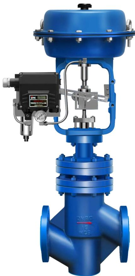
DBC F 型单座衬氟调节阀它由轻小型多弹簧气动薄膜执行机构或电子式电动执行机构和直通单座衬氟阀两部分组成。由于阀门接触介质的部位均采用高压注塑工艺衬有能耐腐蚀，耐老化的聚全氟乙丙烯（简称 F46）或 PFA，填料函密封采用聚四氟乙烯波纹管密封。因而该调节阀能广泛用于化工、石油、冶金、医药、电力等行业中对酸、碱等强腐蚀介质和有毒、易挥发等气体、液体介质的过程控制。体积小，重量轻，调节精度高。
