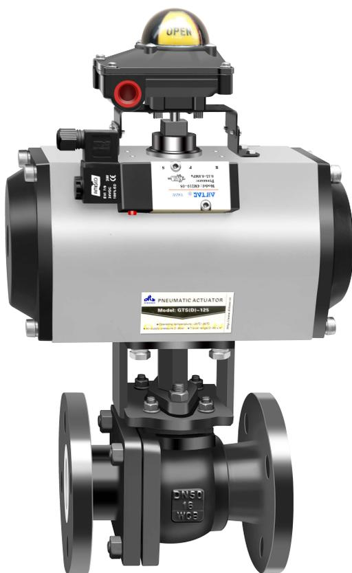
气动衬氟塑 O 型球阀是旋转式切断型球阀，它由气缸活塞式执行机构和衬氟塑球阀两部分组成。由于该阀内腔及球体均采用高压注塑工艺，衬有耐腐蚀、耐老化的聚全氟乙丙烯（简称 F46），故具有可靠的耐腐蚀性和密封性。能广泛适用于化工、石油、冶金、医药、电力等工业部门，实现对生产过程中酸、碱等强腐蚀介质的调节或切断。
